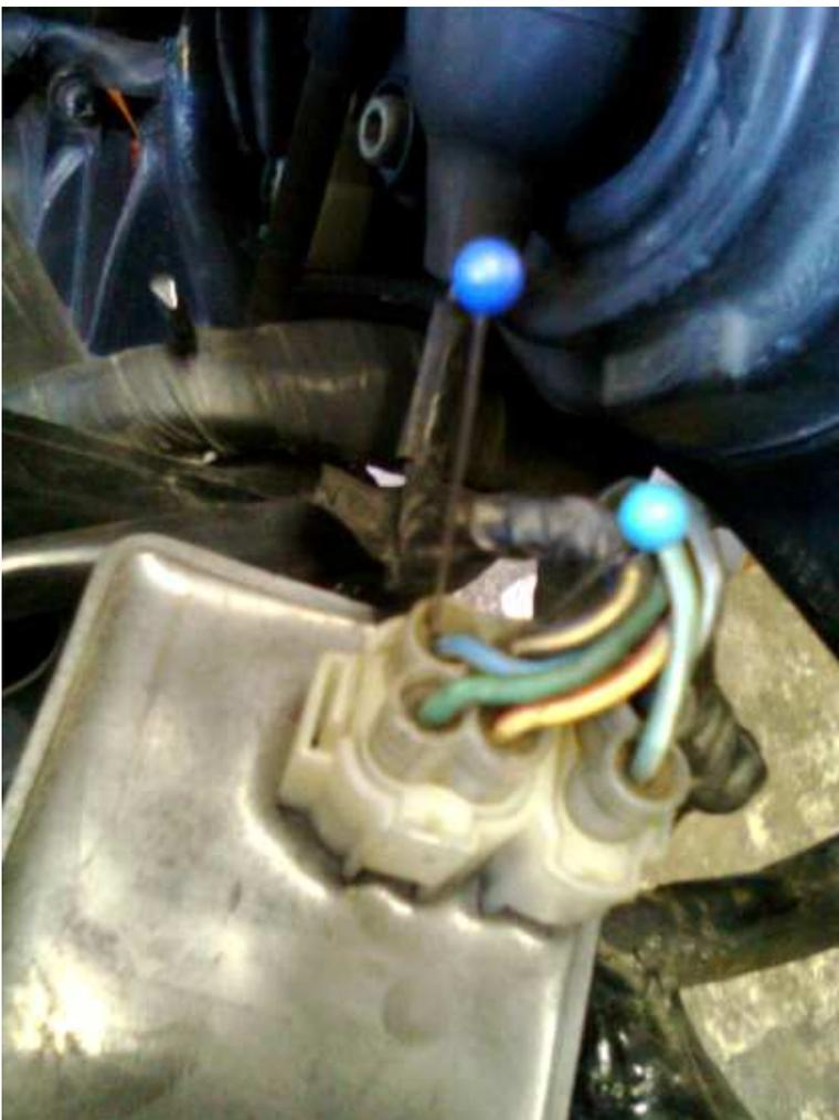
Per non interrompere l'impianto elettrico originale a fini del test, è possibile utilizzare degli spilli da sarto con la pallina in plastica ed inserirli nel connettore fino in fondo oppure direttamente nei fili interessati effettuando un piccolo buco fino a raggiungere i conduttori in rame.
